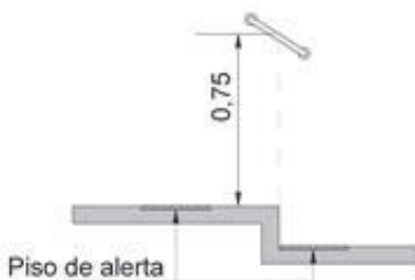
a) Barra de apoio inclinada
