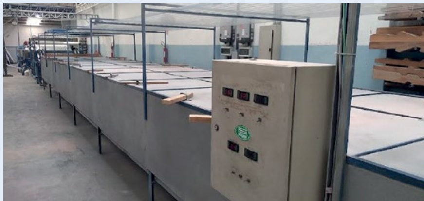
Figura 2 - Linha de produção da telha de PRFV
