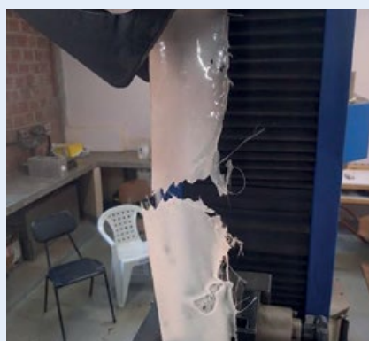
Figura 7 - Tira de PRFV (corpo de prova) rompida ao esforço de tração na máquina universal
