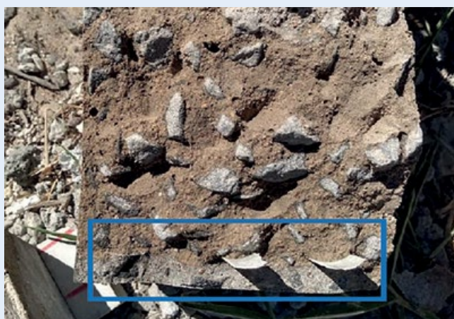
Figura 13 - Corpo de prova rompido com ênfase à interface de aderência entre as tiras de PRFV e o concreto
