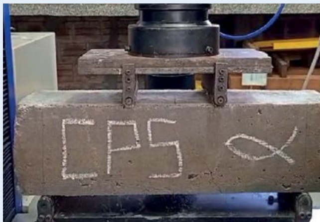
Figura 11 - Corpo de prova rompido, mas ainda unido em decorrência da não ruptura da fibra aderida ao concreto
