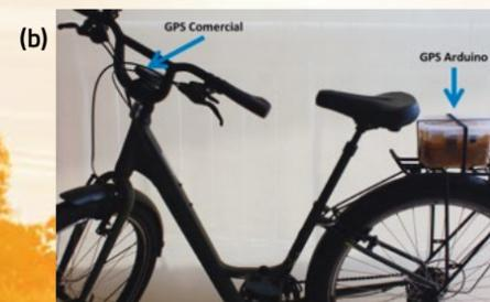
**Figura 1: Esquema do Protótipo de GPS e GPS embarcados em uma bicicleta**
