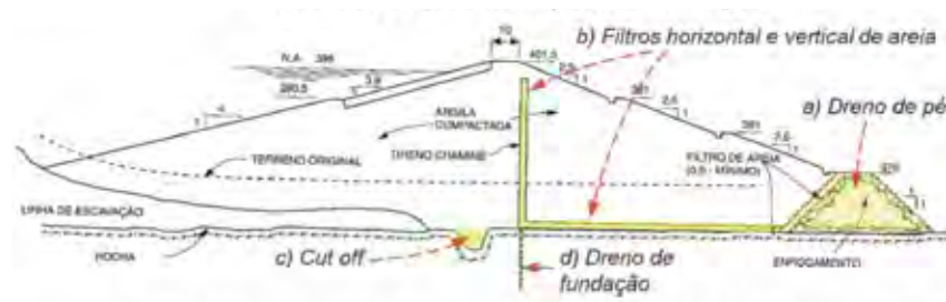
Figura 10 - Barragem com cut-off, filtros vertical e horizontal de areia e drenos de fundação e de pé
