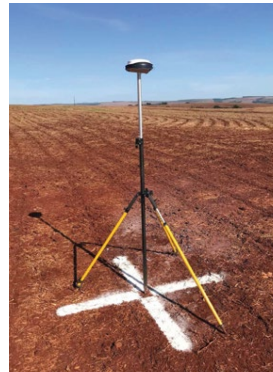
Georreferenciamento de ponto de controle fotovisível de apoio ao aerolevantamento
