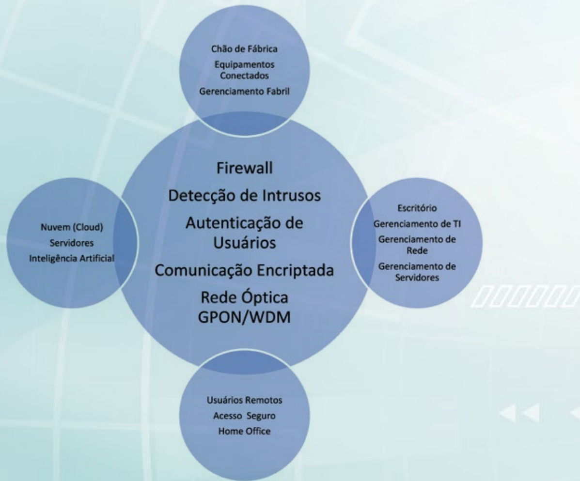
Ilustração de sugestão de arquitetura de segurança para uso IIOT
