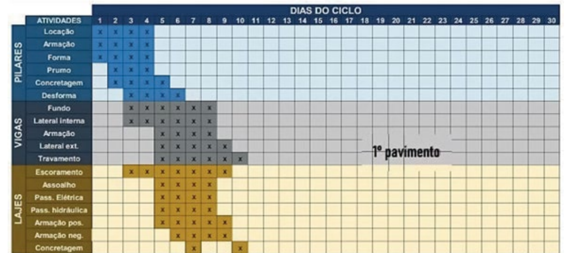
Figura 02 - Ciclo padronizado de um pavimento
